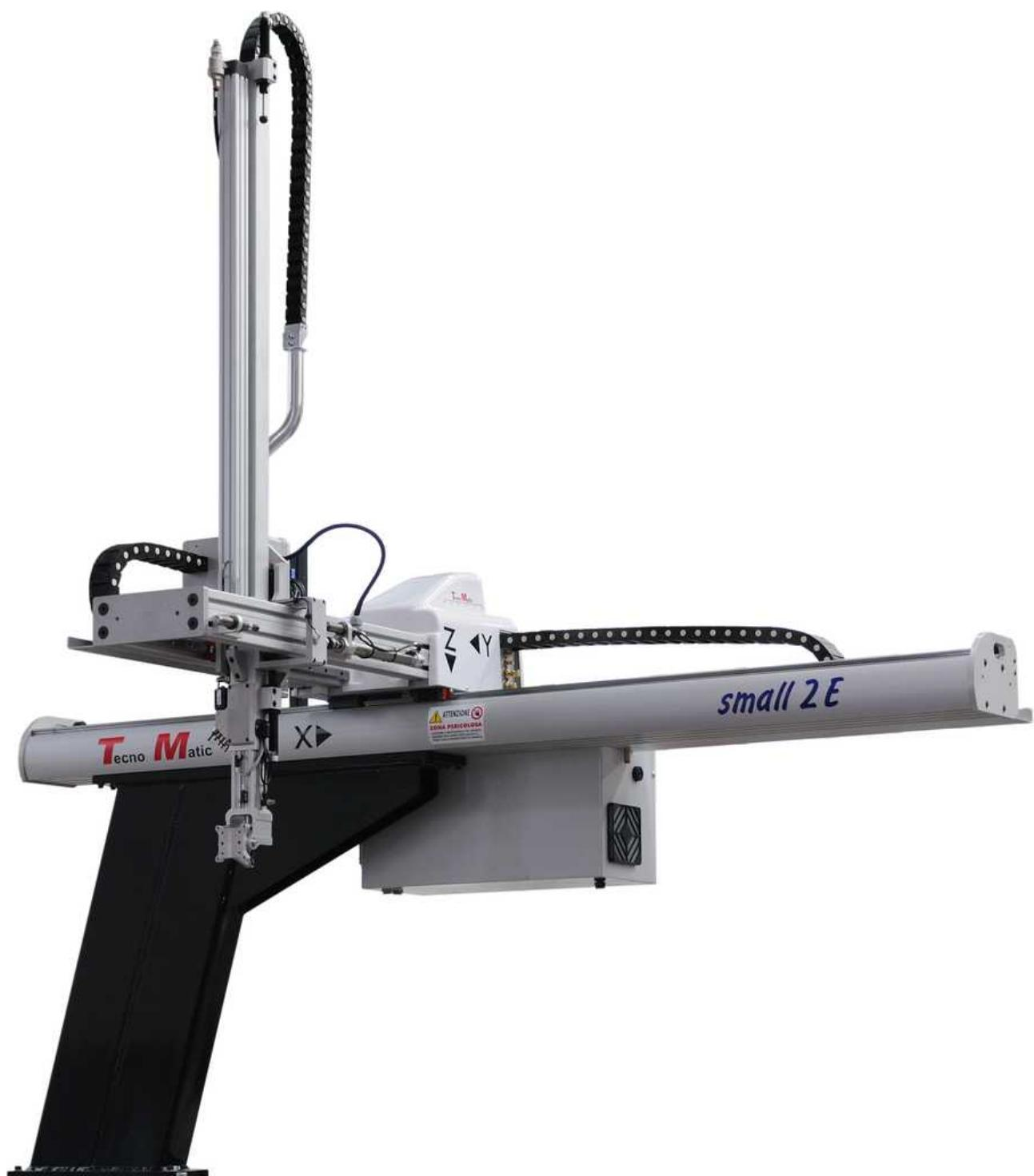
Роботы серии SMALL отвечают большинству требованиям по экономичности и гибкости применения на литьевых машинах малой и средней мощности.
